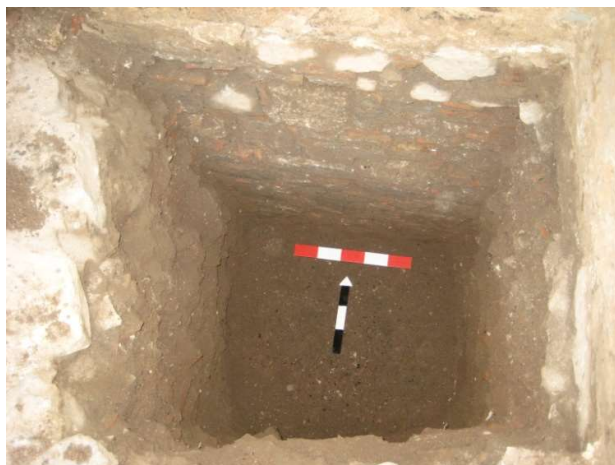
Εικόνα 13: Χαρακτηριστική εδαφική τομή σε βάθος 2.90m από το επίπεδο της οδού Παίδων.
