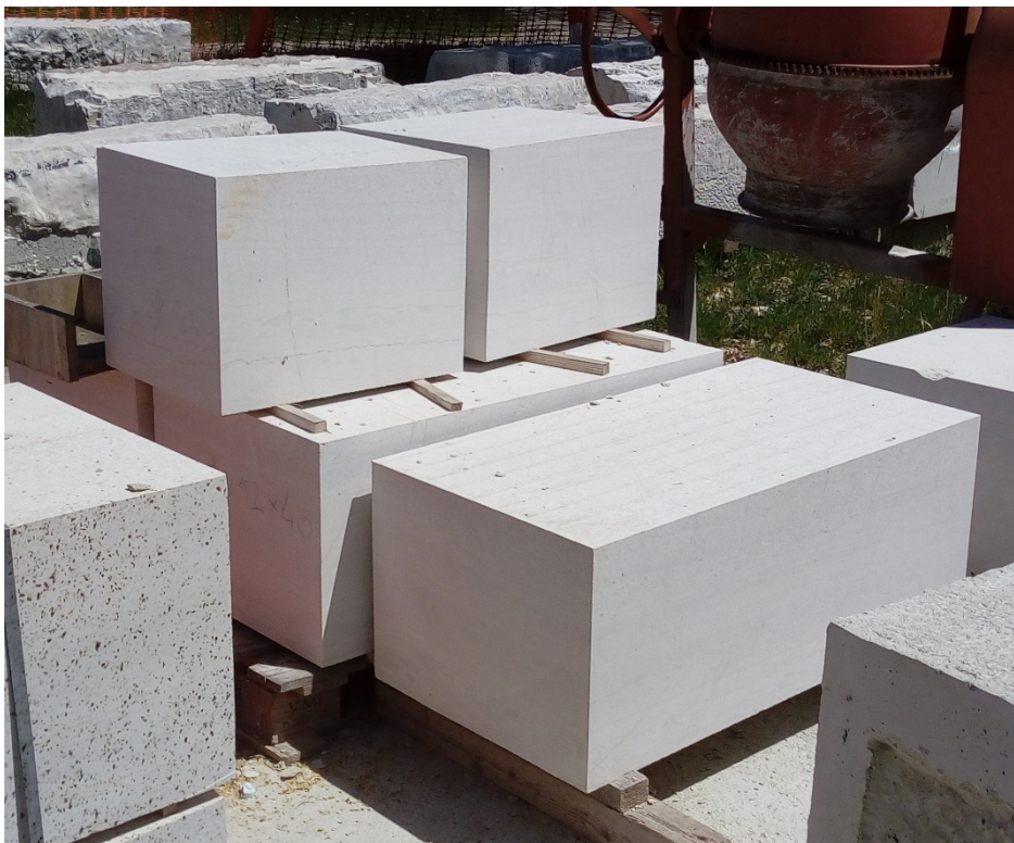
Εικ. 1: Ενδεικτικά τεμάχια τοπικού ασβεστόλιθου που χρησιμοποιούνται στις εργασίες αποκατάστασης του Θεάτρου ως συμπληρώματα εδωλίων για την γεωμετρική και αισθητική τους αποκατάσταση. (ΕΦΑΙ)
